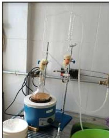
**Figure 25** : Appareil de l'extraction des huiles essentielle (Clevenger) (**photo personnelle**)
