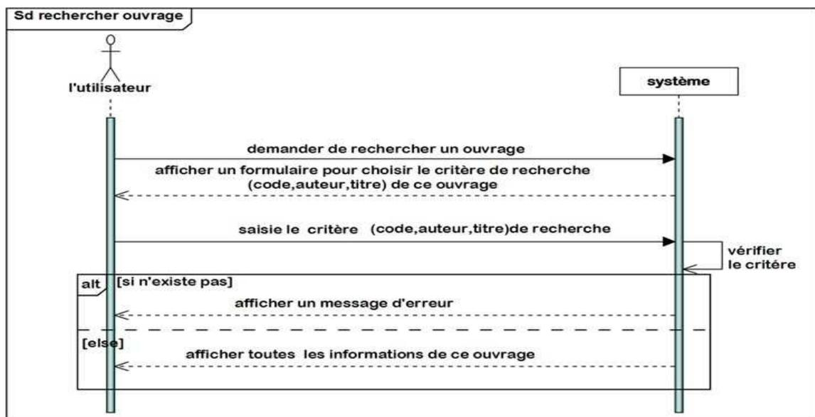
Figure II.18 : Diagramme de séquence du cas Rechercher ouvrage.
