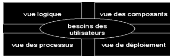
Figure 2.2 : les différentes perspectives qui définissent un modèle d'architecture
