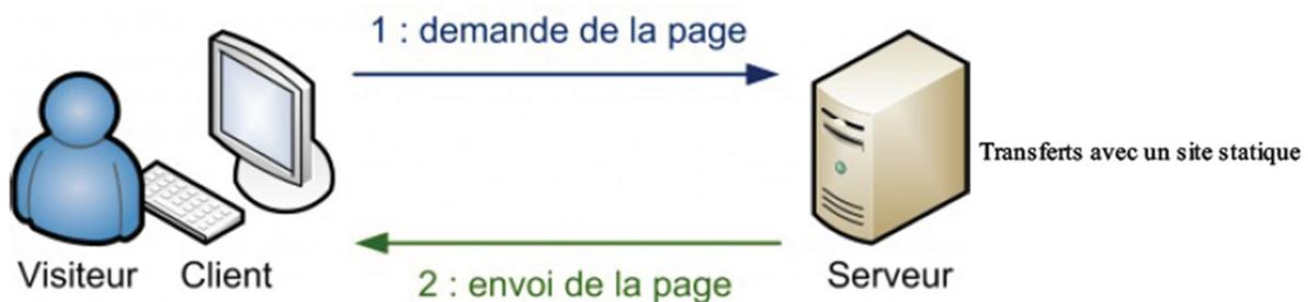
Figure 1.4. Fonctionnement d'un site statique.
