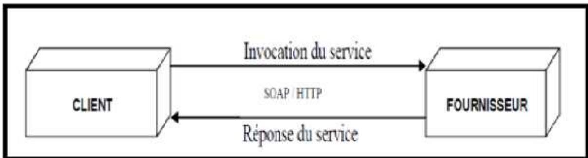
Figure 3. Fonctionnement d'un service web à accès non public
