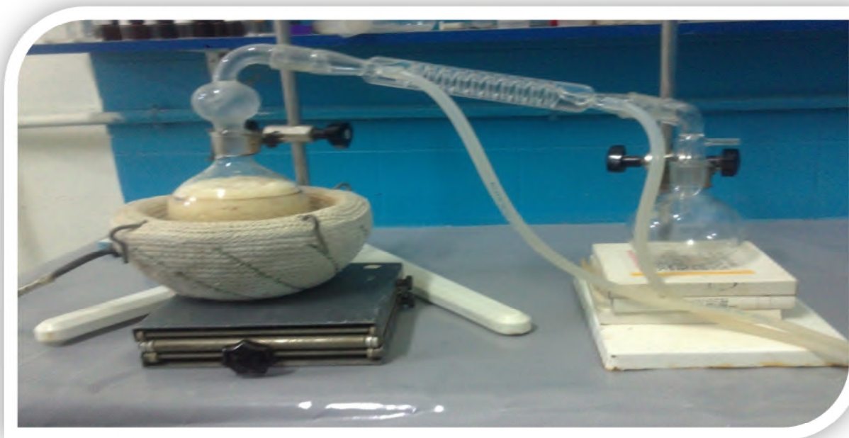
Figure 07: montage d'hydrodistillation utilisé dans l'extraction des huiles essentielles d'oignon.
