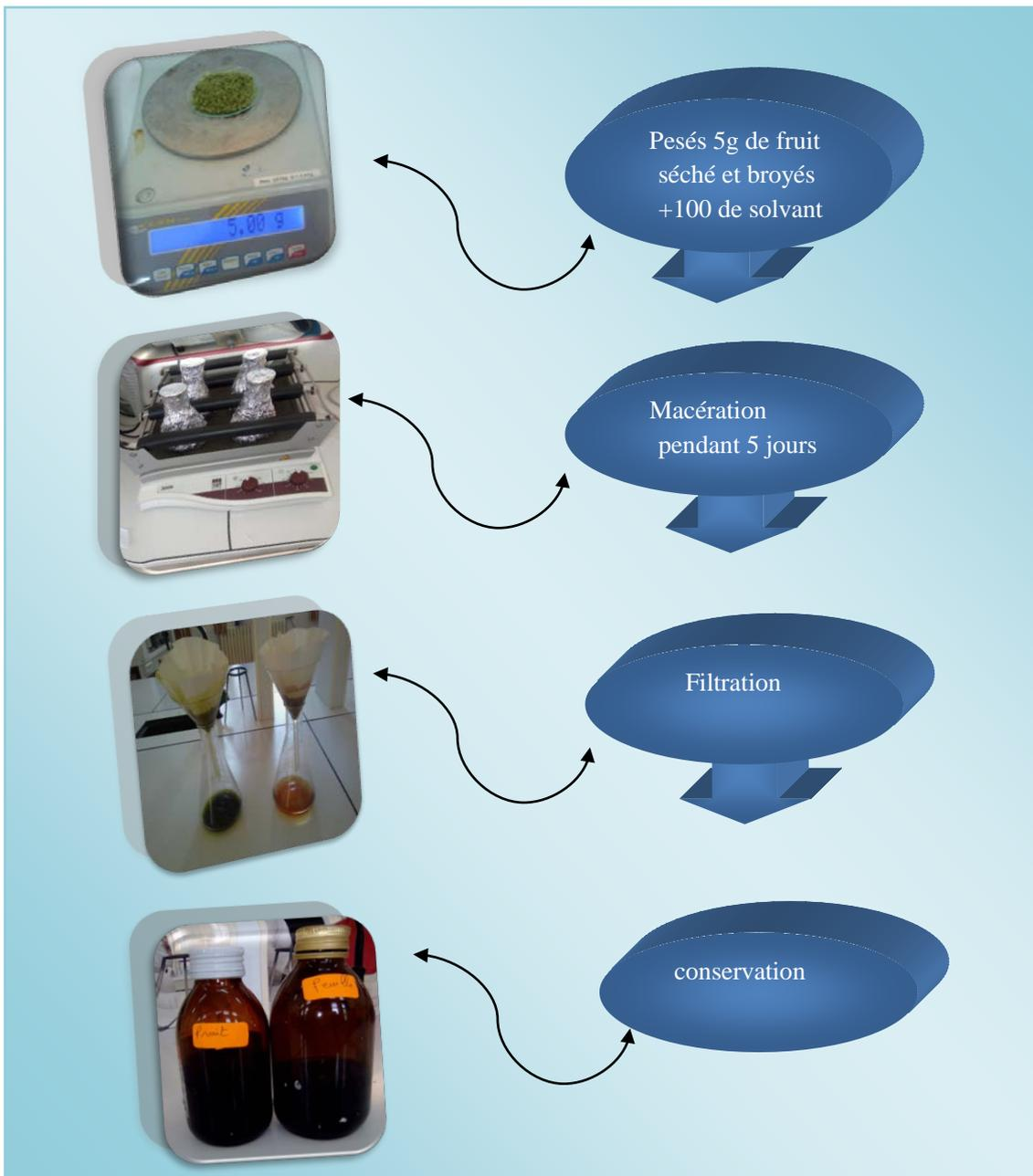
**Figure 19:** Représentation schématique des étapes réalisées dans l'extraction de polyphénols
