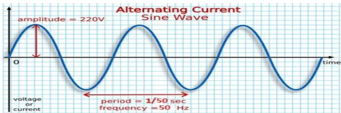
Figure III.10 :L'onde sinusoïdale de 220V AC. [34]
