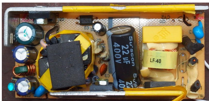
Figure III.18 : La carte PCB de l'alimentation 12V 5A 60W du côté composant LE (trou traversant). [38]
