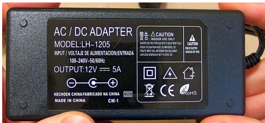
Figure III.17 : L'étiquette indique AC/DC Adapter Model LH-1205. 12V 5A 60W. L'entrée est de 100-240V 50-60Hz. [38]
