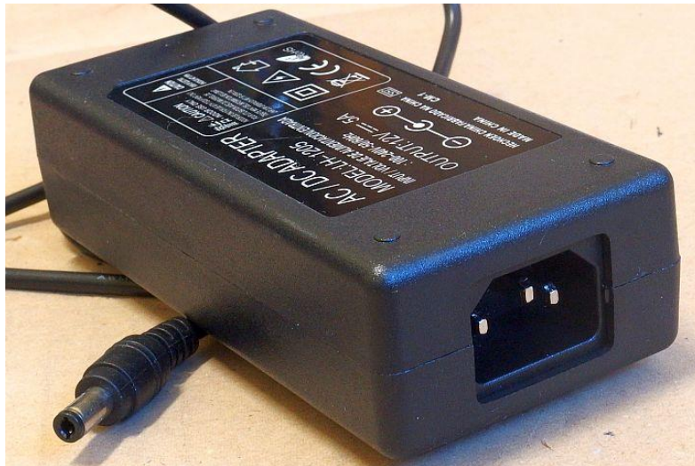
Figure III.16 : Alimentation à découpage chinoise 12V 5A 60W. [38]
