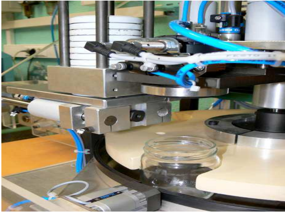
Figure I.3 : Capsuleuse Ravoux Tâche répétitive, Cadence élevée. [4]
