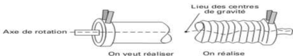
Figure I.9: Balourd dû à la tolérance d'usinage sur le rotor
