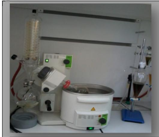
Figure 5 : Etape d'évaporation et de concentration de l'extrait au moyen d'un rotavapeur (Büchi R-134).
