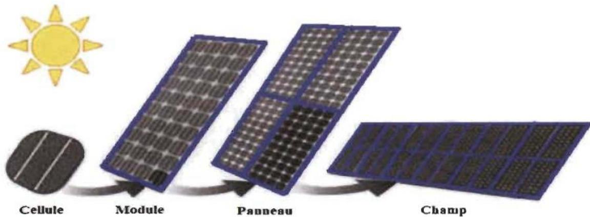
Figure I.9 : Configuration des cellules photovoltaïques [24].
