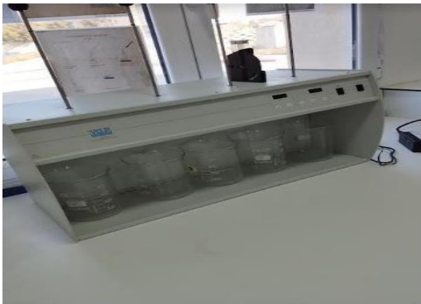
Figure I.7. Essais de jar -test (Station El- Maouane
