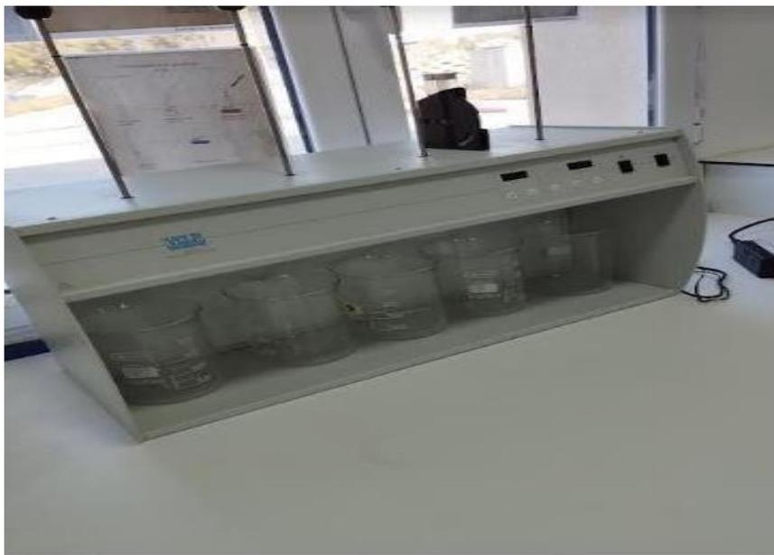
Figure I.7. Essais de jar -test (Station El- Maouane
